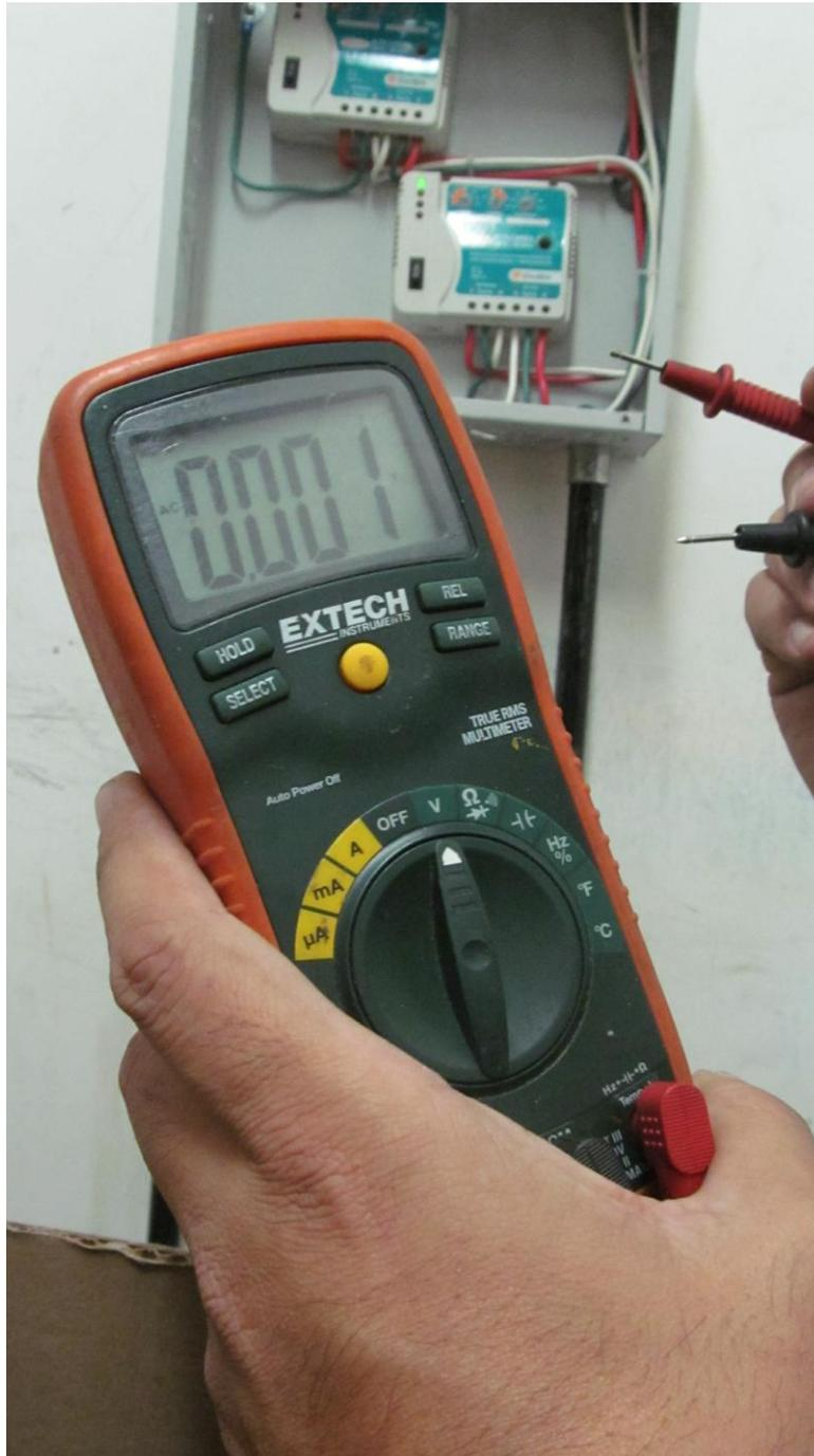
Anexo 8 – **INSTALACIÓN ACTUAL:** Cero del instrumento de medición
